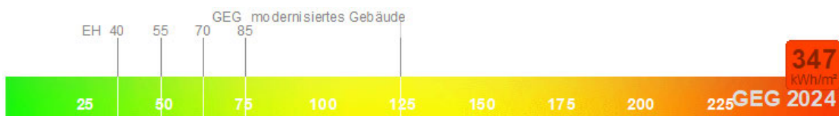
Abbildung 22: Primärenergiebedarf des betrachteten EFH nach DIN V 18599
